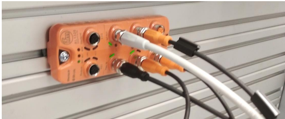
Un dispositivo IO-Link maestro montado en el JMTS
