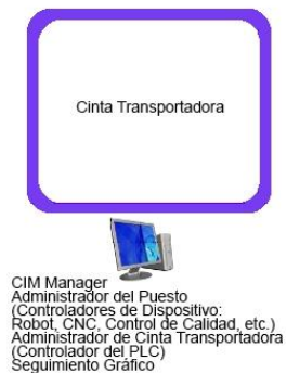
Figura 2-9: Módulos de OpenCIM concentrados en una sola computadora
