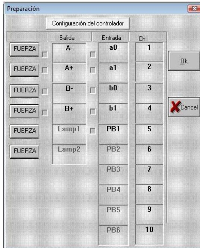
Todas las conexiones eléctricas de entrada y salida realizadas en el diagrama de circuito se encuentran disponibles en el cuadro de diálogo 'Setup' (Configuración).
