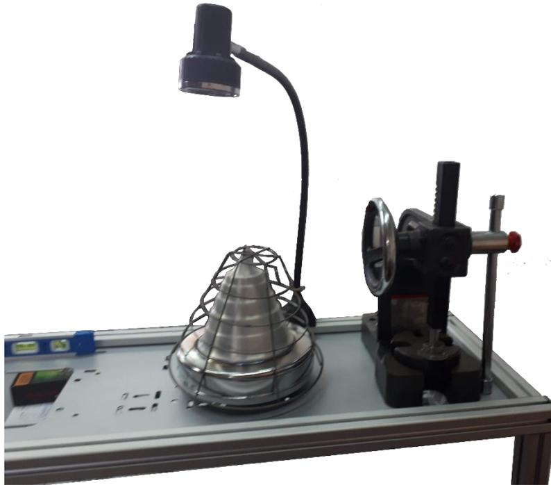
La prensa (36-0900-0012) se fija a la superficie de trabajo en la posición y orientación mostradas aquí y utilizando los tornillos hexagonales (2), las tuercas hexagonales (2), las arandelas planas (4) y las arandelas de seguridad (2) que se incluyen. Consulte el mapa 5.2.2 para el montaje del ensamblaje en la página 21 para conocer la ubicación exacta de las ranuras de los tornillos.5.2.2Mapa para el montaje de la estructura21
