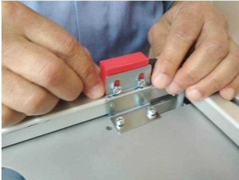
4. Coloque el protector de seguridad sobre la superficie de trabajo. Asegúrese de que los dos cabezales de lectura se tocan y están alineados. Si no lo están, retire el protector de seguridad y ajuste la altura del cabezal de lectura conectado al controlador. Vuelva a colocar el protector de seguridad para confirmar la alineación.
