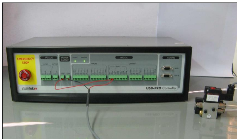
Figura 4-10: Ejemplo de conexión de la válvula de la pinza neumática (conexión frontal)
