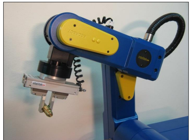
Figura 4-8: SCORBOT-ER 9Pro con pinza neumática
